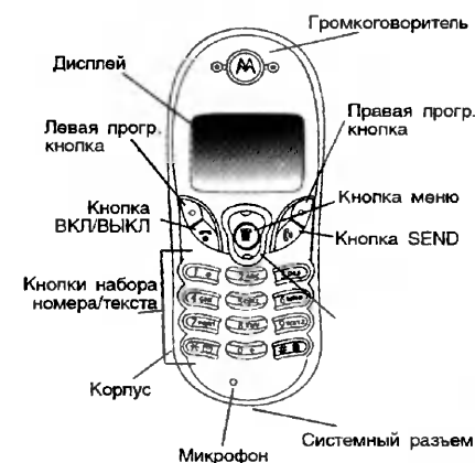
Рис. 1. Передняя панель телефона с кнопками набора номера и управления
